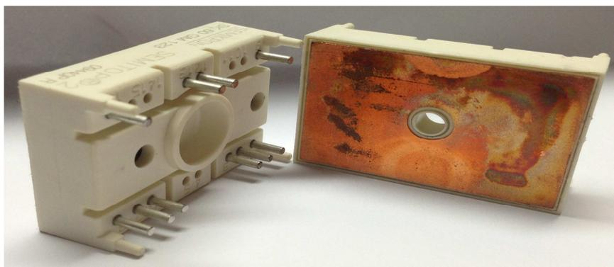
Figura A.4 Interruptor bidireccional SEMIKRON XXX
